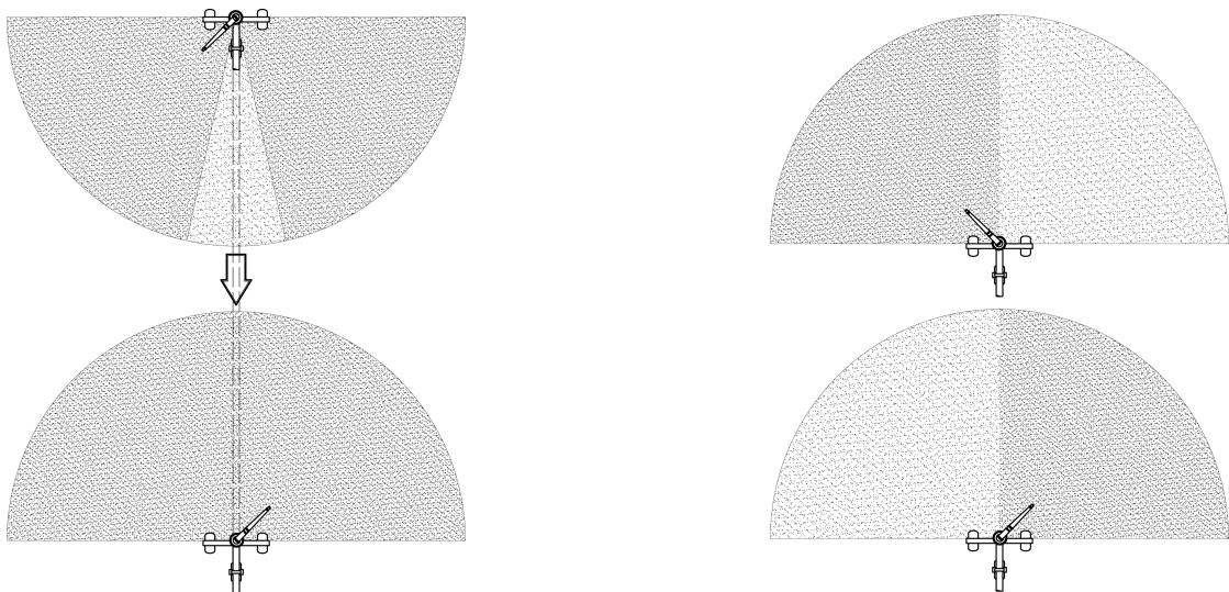
Ciclo automatico di inversione per macchine semoventi
